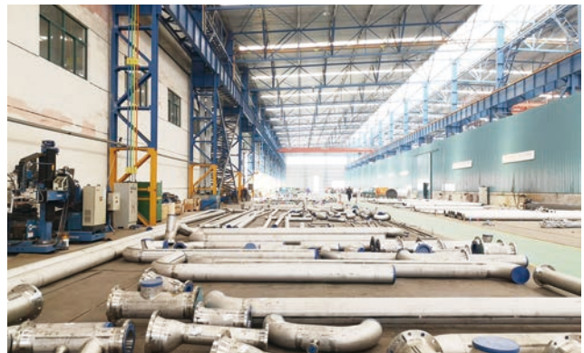
▲ 管舾车间 & 不锈钢管制作中心 (202m x 120m)
